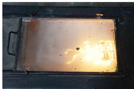
Образец кровельной системы с полимерной мембраной LOGICROOF V-RP и защитным материалом LOGICROOF NG
