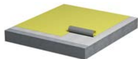
1. Монтаж первого слоя гидроизоляции.
