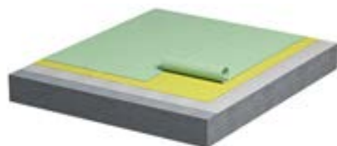
2. Монтаж второго слоя гидроизоляции.
