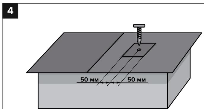
При возникновении зон механического крепления через материал, зону крепления необходимо усилить дополнительным слоем материала шириной не менее 50 мм по обе стороны от крепления. Усиление укладывается на тонкий слой битумной мастики.
