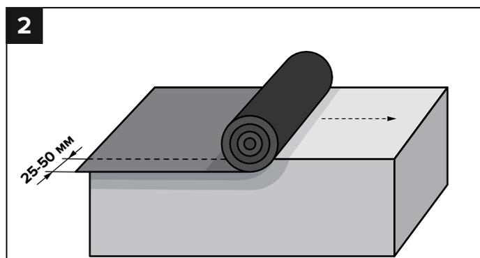
На основание, обработанное мастикой уложить материал так, чтобы он выступал за габариты будущих стен на ширину не менее 25–50 мм.
