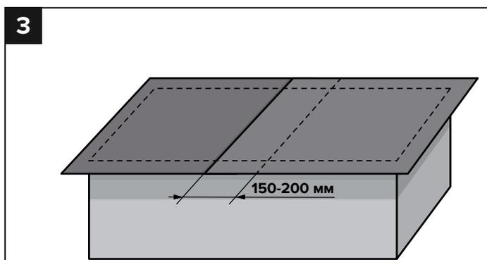
На место поперечного перехлеста наносится тонкий слой битумной мастики. Ширина поперечного перехлеста составляет 150–200 мм.
