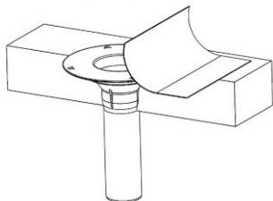
5. Прорежьте кровельный ковер по диаметру водоприемной воронки.
