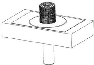
7. Изменять высоту листоуловителя можно путём подрезки его нижней части, используя три специальные кольцевые канавки, расположенные на внешней стороне листоуловителя.
