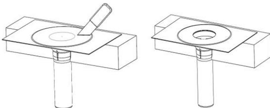
6. Установите листоуловитель в фланцевую конструкцию после окончания монтажных работ.
