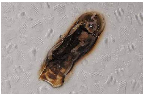
На образце мембраны толщиной 1,5 мм был поврежден только верхний слой.
