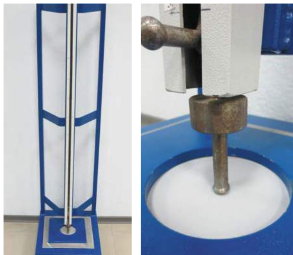
4.3.4 Общий вид установки для проведения испытания на ударную прочность
