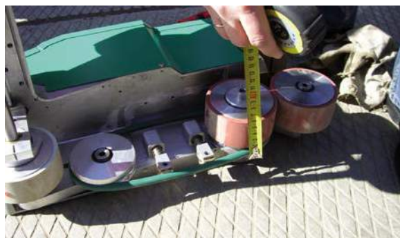
Рис. 3.5.5 Ширина рабочей поверхности Leister Varimat, равная 60 мм
