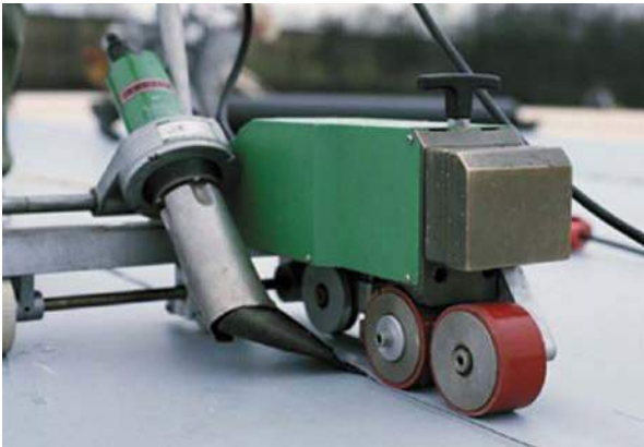
Рис. 5.2.1 Процесс автоматической сварки
