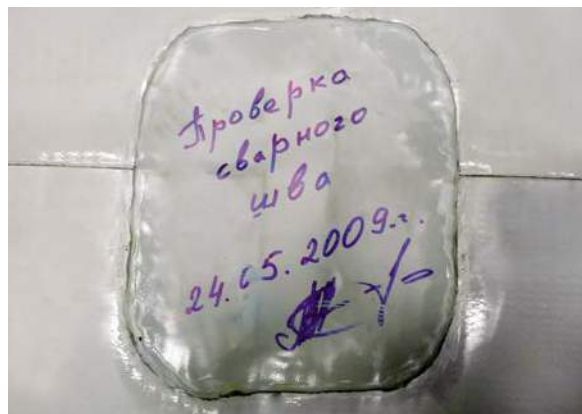
Рис. 5.2.12 Знак качества сварного шва
