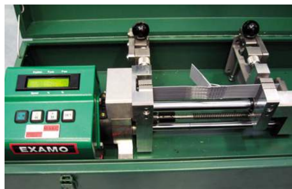
Рис. 5.2.5 Проверка качества сварного шва при помощи Leister Examo
