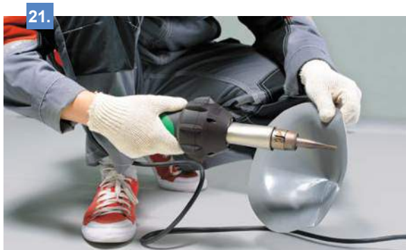
Затем прогревайте небольшой участок нижней части заготовки, двигая соплом фена вдоль него, до тех пока мембрана не станет пластичной.
