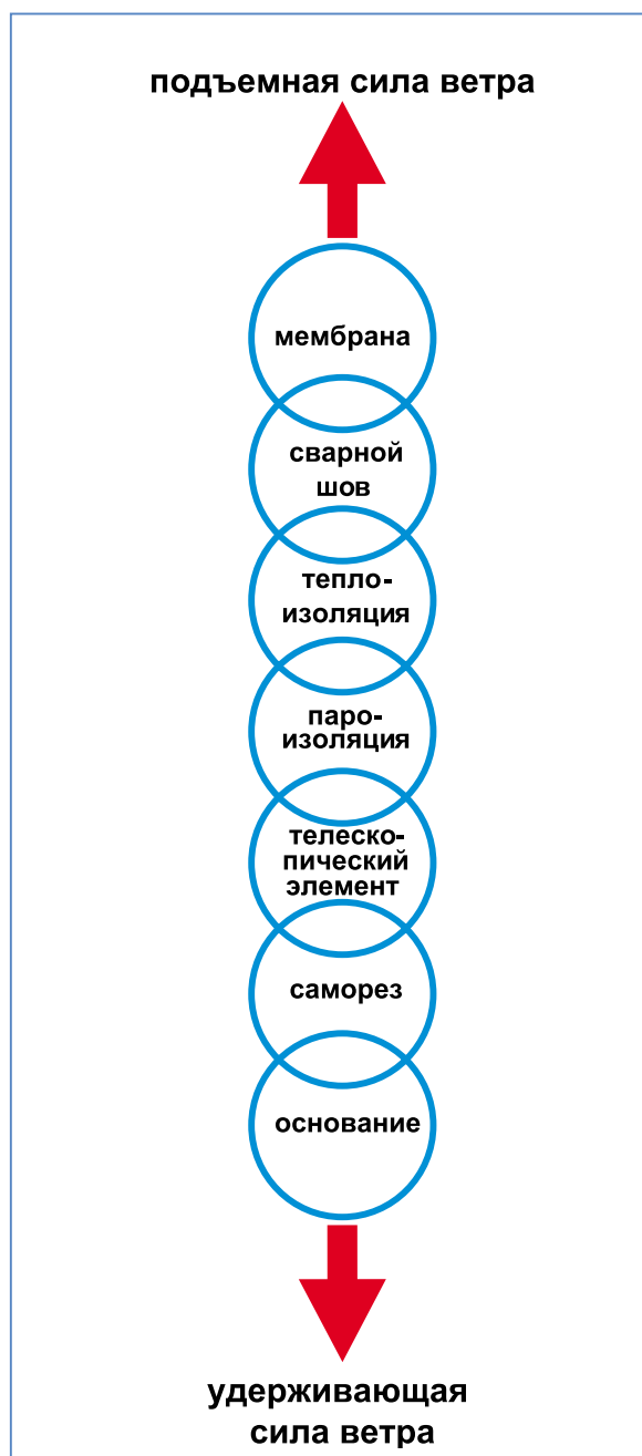
Рис. 3.5.3. Сопротивление подъемной силе ветра
