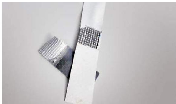
Рис. 5.2.10 Вырезание тестовой полоски из сварного шва
