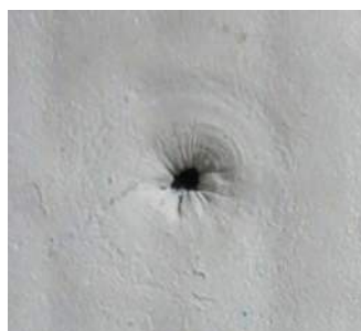
4.3.5 Повреждение на образце мембраны после испытания
